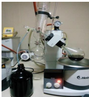
Gambar 1. Proses penguapan menggunakan rotaryevaporator
