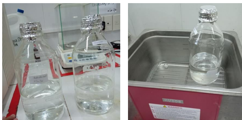
Gambar 4. Gambar Reagen yang Sudah disonifikasi dan Proses Sonikasi
