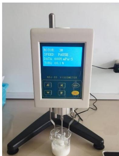
Gambar 3.2. Hasil Uji Viskositas Lotion dengan Ekstrak Daun Salam
