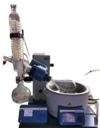
Gambar 2.1. Proses Evaporasi Simplisia Daun Salam
